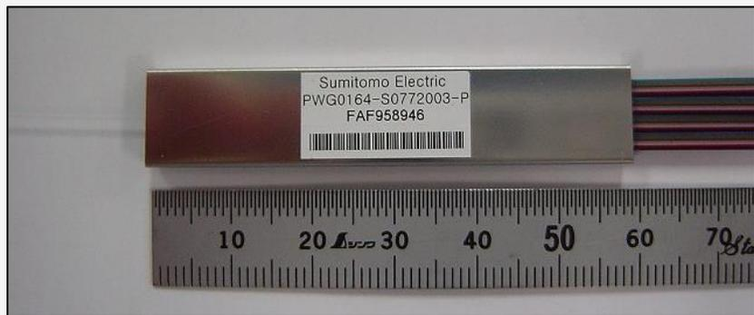
O Splitter Óptico, ou Divisor Óptico, é um elemento totalmente passivo utilizado em Redes FTTx que realiza a divisão do sinal óptico proveniente de uma fibra para várias outras, assim, divide o sinal óptico de sua entrada em suas portas de saída. Como é um elemento passivo não regenera sinais, ou seja, não recupera eletricamente ou opticamente sinais, por esta razão não necessita ser alimentado eletricamente.
