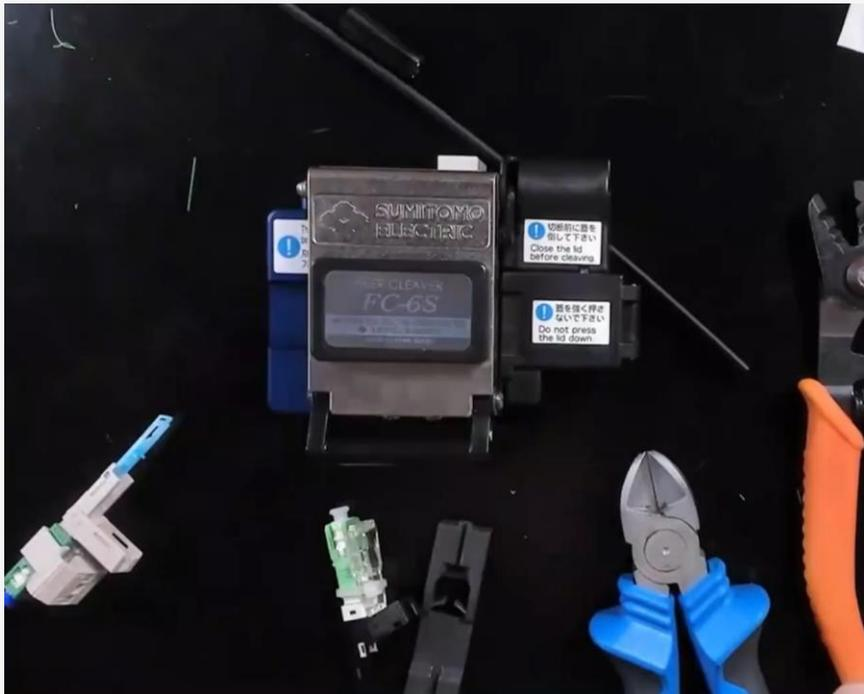
Além das ferramentas básicas, o Instalador FTTH deve ter o domínio sobre ferramentas específicas para preparar a fibra óptica para uma junção óptica, seja por uma conexão ou fusão.
