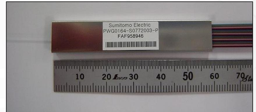
O Splitter Óptico, ou Divisor Óptico, é um elemento totalmente passivo utilizado em Redes FTTx que realiza a divisão do sinal óptico proveniente de uma fibra para várias outras, assim, divide o sinal óptico de sua entrada em suas portas de saída. Como é um elemento passivo não regenera sinais, ou seja, não recupera eletricamente ou opticamente sinais, por esta razão não necessita ser alimentado eletricamente.
